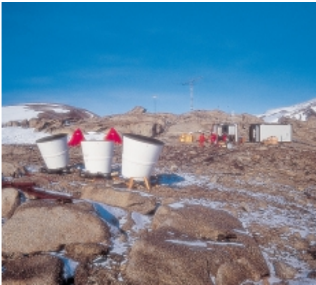
▲ Antenne SODAR per la misura della velocità del vento
