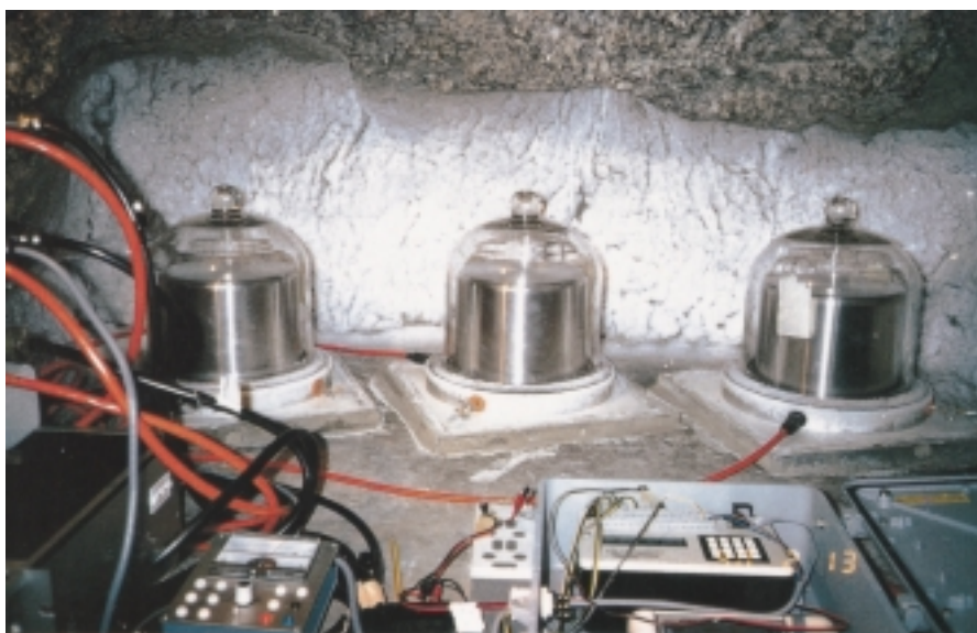
◀ La stazione sismica presso la base italiana di Baia Terra Nova e la strumentazione per i rilievi sismici a larga banda in galleria (da: Boschi e Meloni, 1991)
