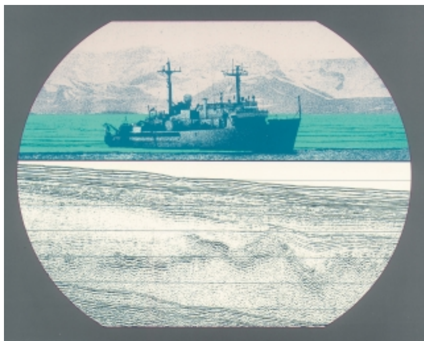
Profili sismici nel Mare di Ross effettuati dalla S.P. Lee (USA). La sezione sismica taglia il contatto tra crosta continentale (a sinistra) e crosta oceanica (a destra) (da: Eittrheim e Hampton, 1987)
